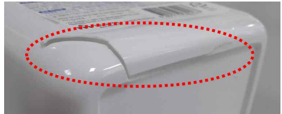
파손 또는 누액 발생 여부 확인
